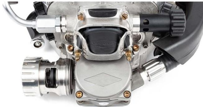
ダイヤモンドの中核をなすエグゾースト（排気）システムです。側面の排気切替ハンドル②を切り替えることにより、簡単に「水中」「水面」の排気排出を切り替えることができます。
