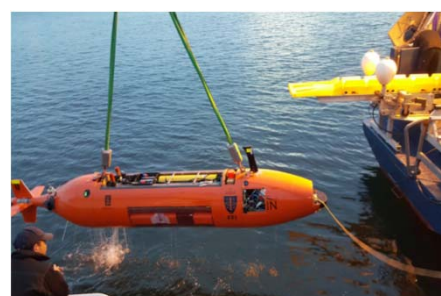
AUV HUGINIに搭載されたWBAT (ノルウェー オスロフィヨルドにて)
