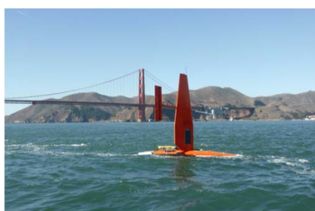
NOAAのセイル式航走体上で 試験中のWBAT (カリフォルニア州サンフランシスコ湾にて)
