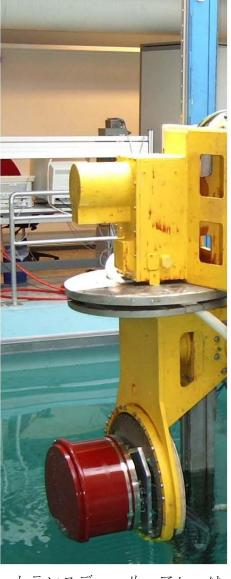
トランスデューサ・アレーは SIMRAD の試験所でテストと構 成のために設置されます。
