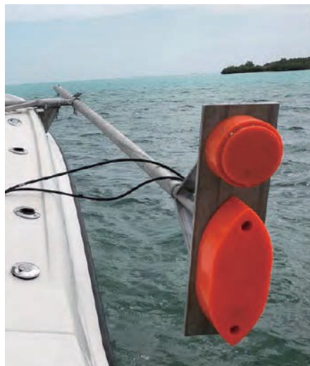
左) 舷側装備例 (上 : 200kHz、下 : 38/200kHzコンビ) 右) 船上での使用例
